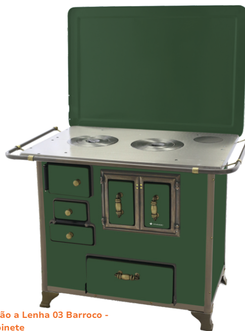
TRADICIONAL PORTA FOGO (FORNALHA) (1) PORTA DO AR (2) GAVETA DAS CINZAS (3) FORNO (4)
